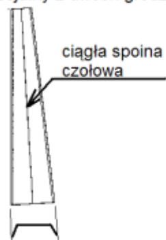
Rysunek 8. Pale specjalne wykorzystywane do zniwelowania pochylenia ścianki
